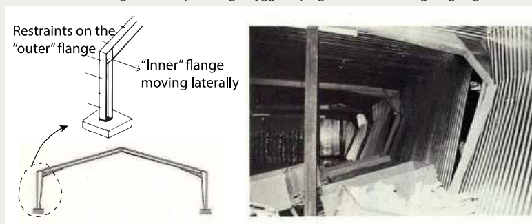
Figur 1. Kollaps av lagerbyggnad på grund av otillräcklig stagning i ramhörn.
